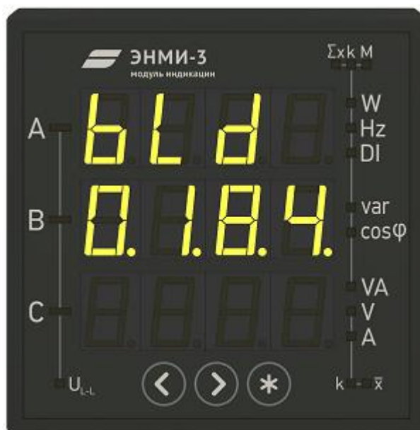
Рисунок 3.6 Версия прошивки ЭНМИ-3
